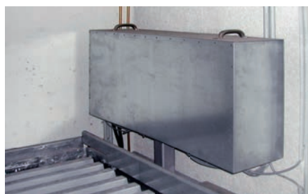
Schallschutzhaube für das Aggregat
